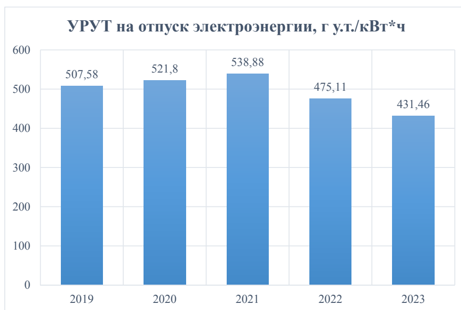
Рисунок *** – Динамика изменения удельного расхода условного топлива на отпуск электрической энергии ТЭЦ АО «РИР»
