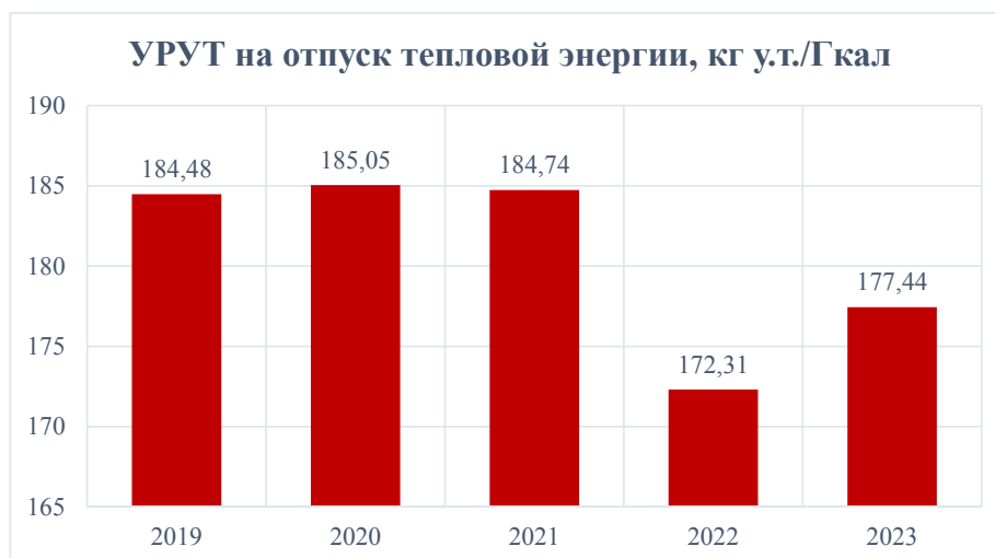
Рисунок *** – Динамика изменения удельного расхода условного топлива на отпуск тепловой энергии ТЭЦ АО «РИР»
