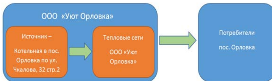
Рисунок *** – Функциональная структура теплоснабжения п. Орловка
